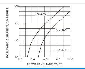
Fig.2 TYPICAL INSTANTANEOUS FORWARD CHRACTERISTIC
