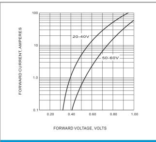
Fig.4-TYPICAL INSTANTANEOUS FORWARD **CHARACTERISTIC**
