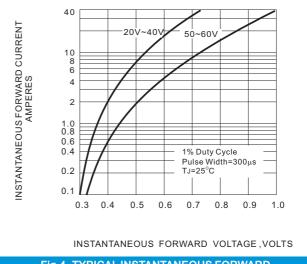
Fig.4- TYPICAL INSTANTANEOUS FORWARD CHARACTERISTIC
