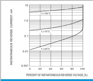
Fig.3- TYPICAL REVERSE CHARACTERISTIC
