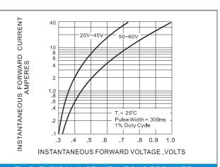
Fig.2- TYPICAL INSTANTANEOUS FORWARD CHARACTERISTICS
