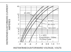
Fig.2- TYPICAL INSTANTANEOUS FORWARD CHARACTERISTICS
