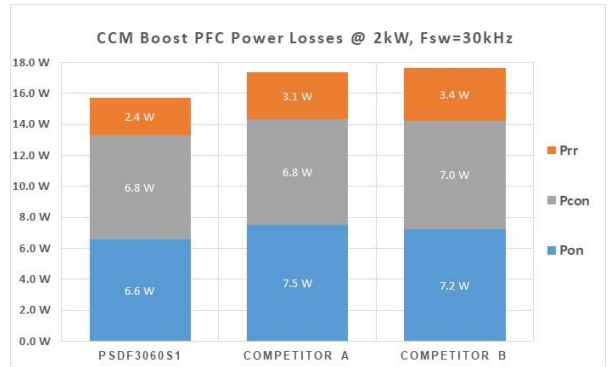
(d) Power loss @ 2kW, 220Vac, 400VDC,
