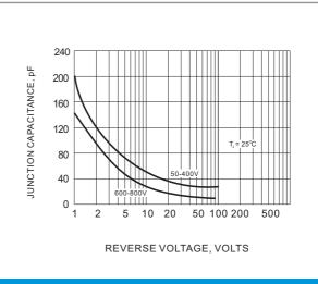
Fig.2 TYPICAL JUNCTION CAPACITANCES
