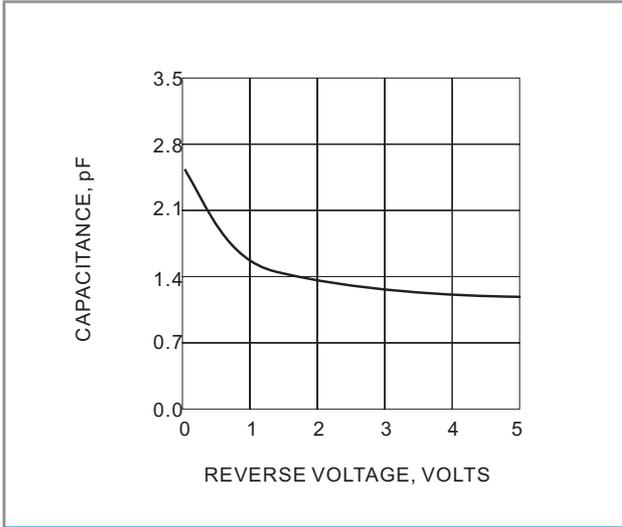
Fig.2 TYPICAL CAPACITANCE vs REVERSE VOLTAGE
